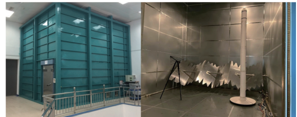
图 1 电磁混响室装置图 Fig.1 Diagram of electromagnetic reverberation chamber setup
