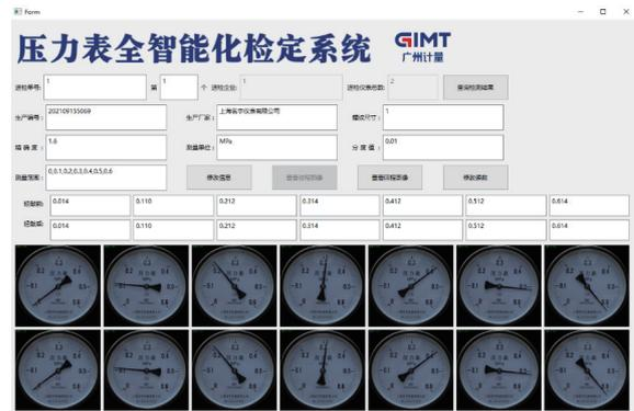
图5 压力表全智能检定系统控制软件的查询界面
